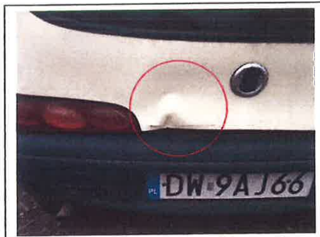
Fot.20. Uszkodzona pokrywa komory bagażnika
